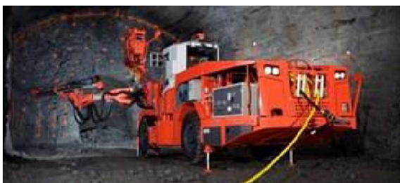
トンネル穿孔機械 (Jumbo)
