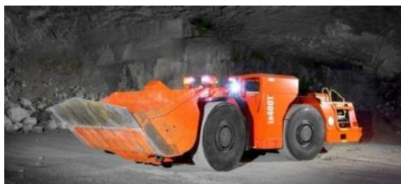
積込み機 (Load Haul Dump)
