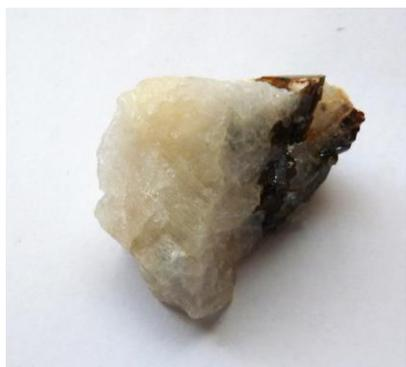
写真 2 氷晶石, Cryolite :  $\text{Na}_3\text{AlF}_6$
