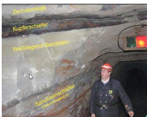
写真3 坑内に露出する含銅頁岩層 下盤からロートリーゲント砂岩層、鉱石鉱物を含むヴァイスリーゲント砂岩層、含銅頁岩層、上盤のツェヒシュタイン苦灰石層が壘重する。ドイツ、マンスフェルト地区、ザンガーハウゼン鉱山坑内。Keith et al. (2017)より転載
