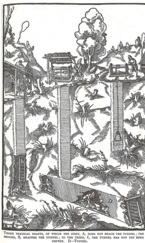
図版5 デ・レ・メタリカ挿図 翻訳本 p.103. 「3本の立坑の図」 A: 坑道に到達していない立坑 B: 坑道に達している立坑 C: まだ立坑に達していない坑道 D: 坑道
