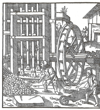
図版6 デ・レ・メタリカ挿図 翻訳本 p.284. 「搗鉱機の図」 A: モルタル B: 直立柱 C: 横木 D: 破碎棒 E: 鉄製ヘッド F: 車軸、 G: 破碎棒上カム、 H: 車軸上カム
